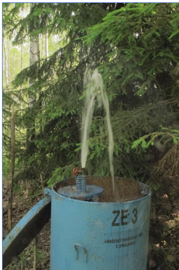
Foto 10: Pohled na tzv. piezometrický vrt ZE3 se skupiny vrtů ZE. Vrt sleduje napjatou hladinu podzemní vody (tzv. artézskou vodu) cca v hl. 10 - 14 m pod povrchem rašeliniště. Artézská voda je dokumentována prakticky pod celou polohou rašeliny a dokládá, že pod rašelinovou polohou je nepropustné souvrství („těsnící strop“), které v podloží udržuje přetlak vody. Měličí vrtů skupiny - ZE1 a ZE2 (sledující zvodeň v hl. 1-4 m, a 4-8 m) v blízkosti vrtu ZE3 zastihují zvodeň s volnou hladinou, která nestoupá nad úroveň okolního terénu. Pravidelné měření hladin z tohoto a několika dalších obdobných vrtů bude zahrnuto do dlouhodobého sledování stavu podzemních vod v severní části Třeboňské pánve. Zároveň bude o data z těchto vrtů doplněn bilanční hydrogeologický model, kterým se každoročně vyhodnocuje dlouhodobá udržitelnost odběrů podzemní vody v oblasti. „I při odběru vody z vrtů mažické linie nesmí vodotrysky přestat tryskat.“
